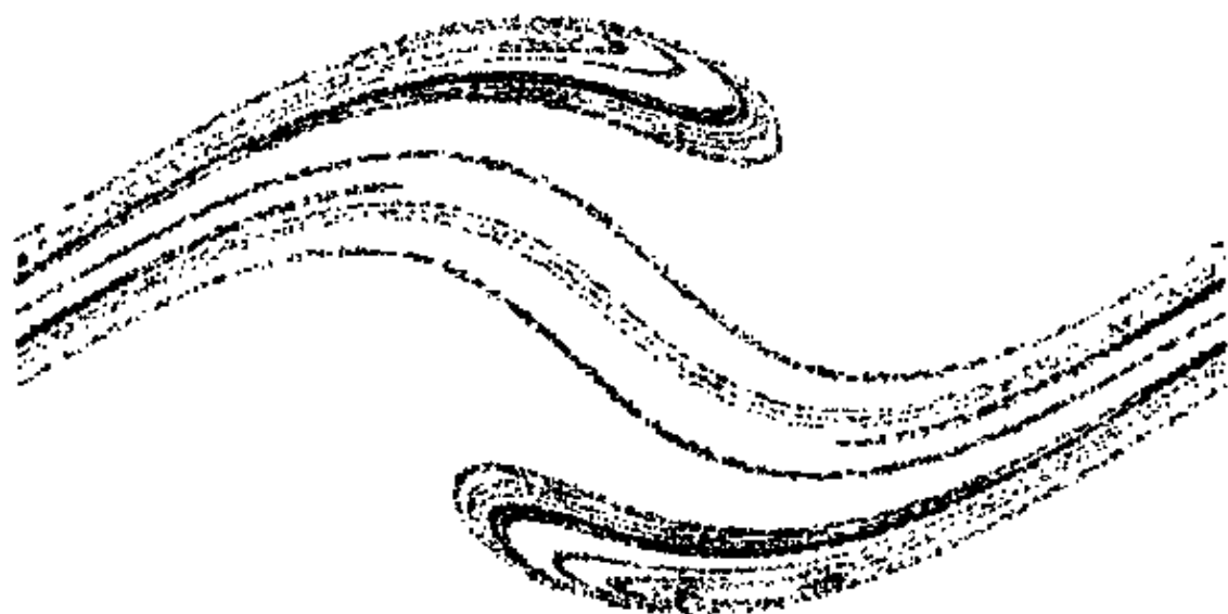
图4 由响应的位移和速度频闪观测采样产生的、参数激励的单摆混沌吸引子
